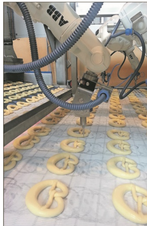
Eine Belauungsmaschine mit Roboterschneideanlage der Firma Abendschön. Sie macht Dekorschnitte an Brezeln, Laugenstangen und Laugenbrötchen. Fotos: Abendschön
